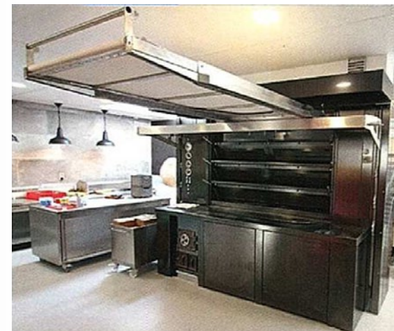
W centralnej czści filii znajduje się trzypółkowy piec rurkowy Woodstone firmy Hein z urzdzeniem załadowczo-wyładowczym. Stylowa czść frontowa wykonana jest z barwionej stali szlachetnej
